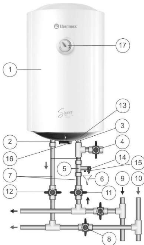
Рисунок 1. Схема подключения ЭВН к водопроводу
