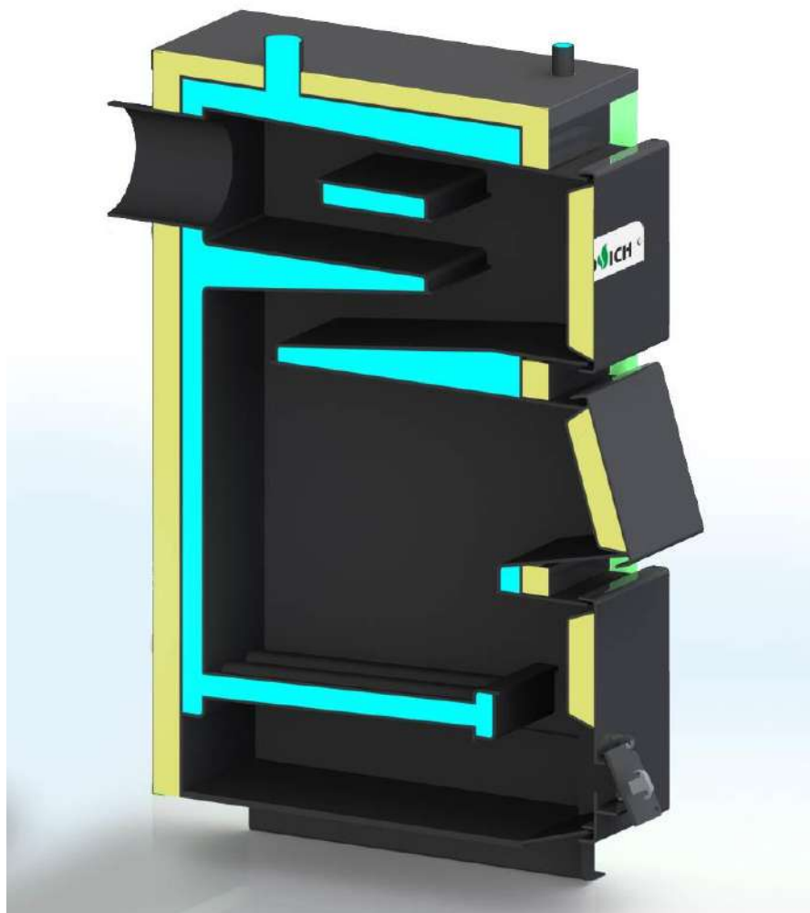
Рис 1.Разрез котла SAKOVICH YANO
