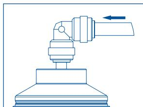
Откройте кран чистой воды на входе в водоочиститель и кран накопительной ёмкости. Убедитесь в отсутствии протечек в водоочистителе.
