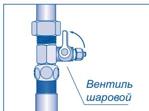
Для исполнения БАРЬЕР ПРОФИ Осмо Boost отключите электропитание повышающего насоса. Закройте кран накопительной ёмкости.
