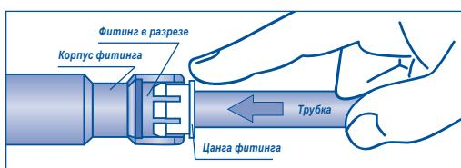
Как правило, при этом не требуется прилагать усилий. Если трубка не выходит из фитинга, не пытайтесь извлечь трубку, прилагая большие усилия. Это приведёт к поломке фитинга и/или разрыву трубы. Проконсультируйтесь со специалистом горячей линии БАРЬЕР.
