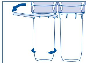
Промойте внутреннюю поверхность колбы струёй горячей воды. При необходимости воспользуйтесь щёткой с моющим средством для посуды, затем обязательно тщательно смойте остатки мыльного раствора. Осмотрите внутреннюю поверхность крышки колбы, протрите влажной чистой салфеткой, при необходимости повторите процедуру.
