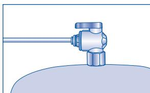
Откройте кран для чистой воды, чтобы сбросить давление, затем закройте кран.
