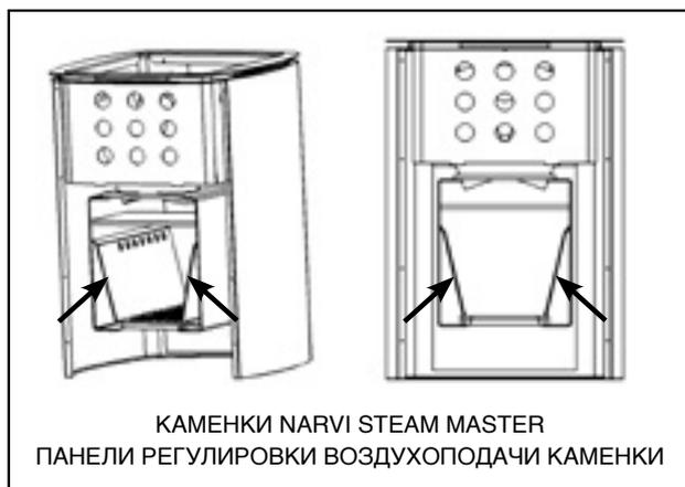
Положение и состояние пластин необходимо проверять регулярно. Печь-каменку нельзя использовать без воздушной направляющей пластины.
