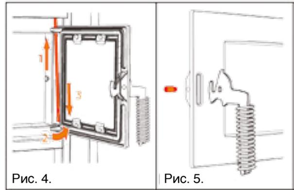
**Рис. 4.** Откройте дверцу, поднимите шток петли (1) настолько, чтобы он вышел из нижнего держателя петли. Прочно удерживая дверцу, поверните нижний конец штока на себя (2) так, чтобы можно было вытянуть шток (3), что позволит снять вместе с ним и дверцу.
