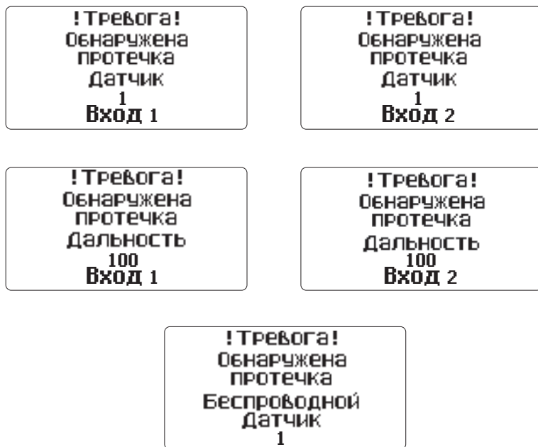
Рис. 9 Сообщения о протечке для разных типов датчиков
