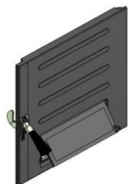
Рис. 3. Регулировочная дверца подачи первичного воздуха
