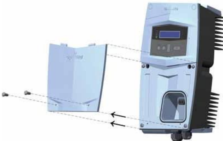
Рисунок 6.8: Демонтаж нижней крышки
