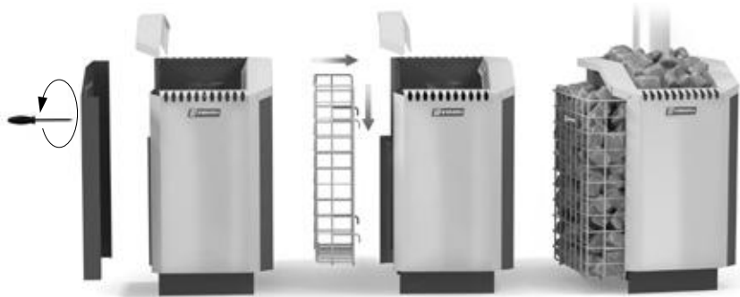
Рисунок-12. Схема установки навесной сетки
