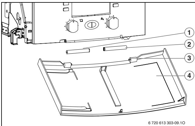
Рис 10 Монтаж крышки
