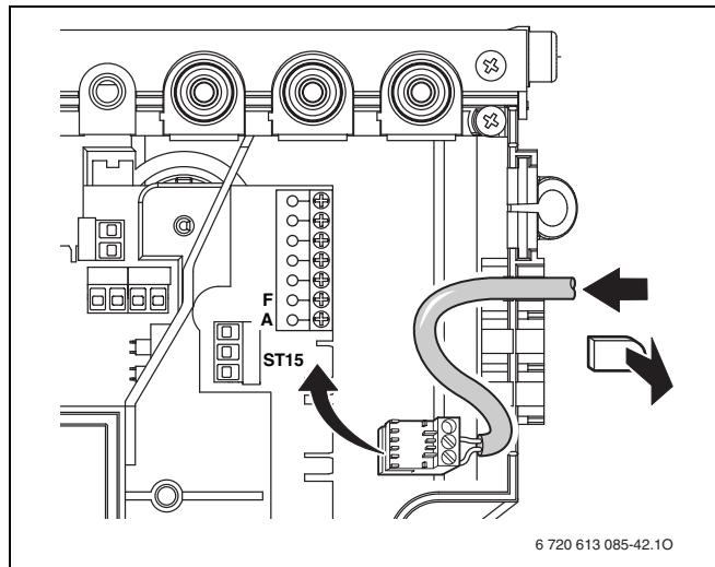
Рис 21 Разъем для подключения датчика температуры бойлера (NTC)
