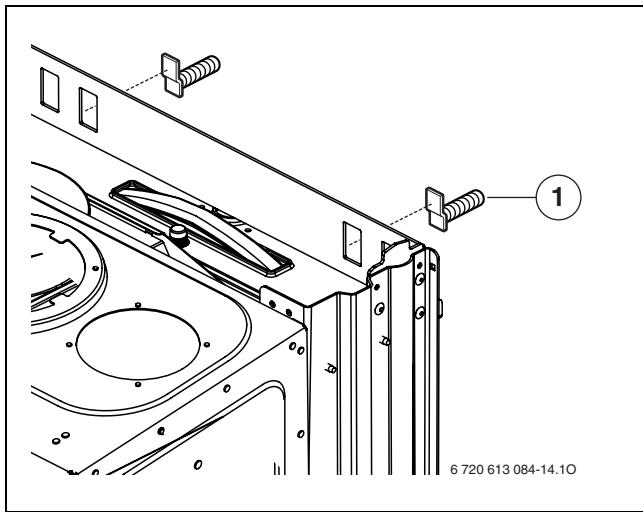
Рис 9 Подвешивание прибора
