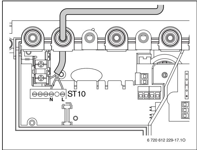
Рис 24 Клеммная колодка для подачи питания ST10
