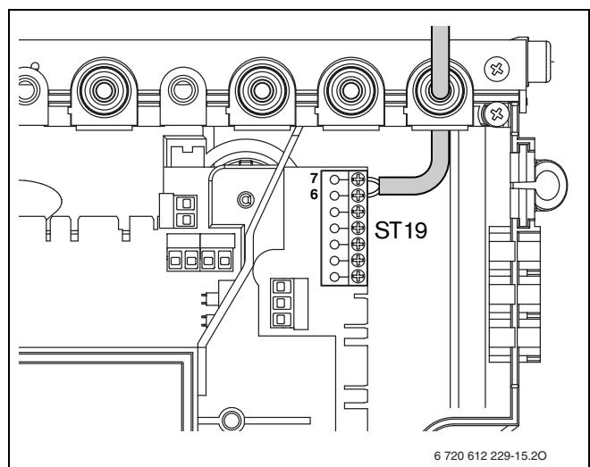
Рис 18 Подключение регулятора
