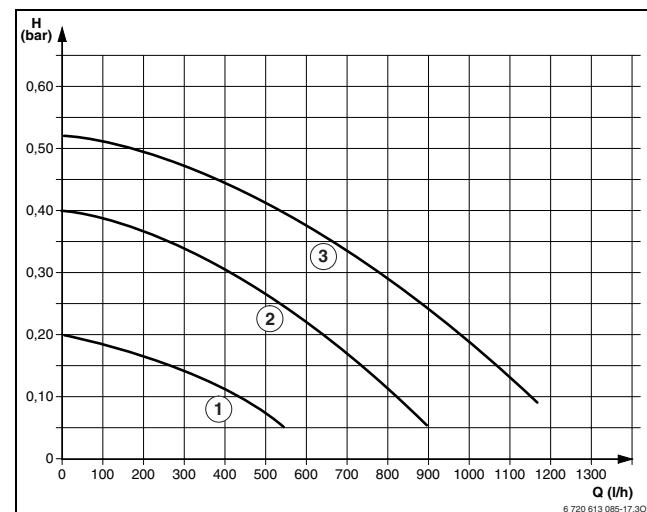
Рис 39 Характеристики насосов при ZSC/ZWC 24-3
