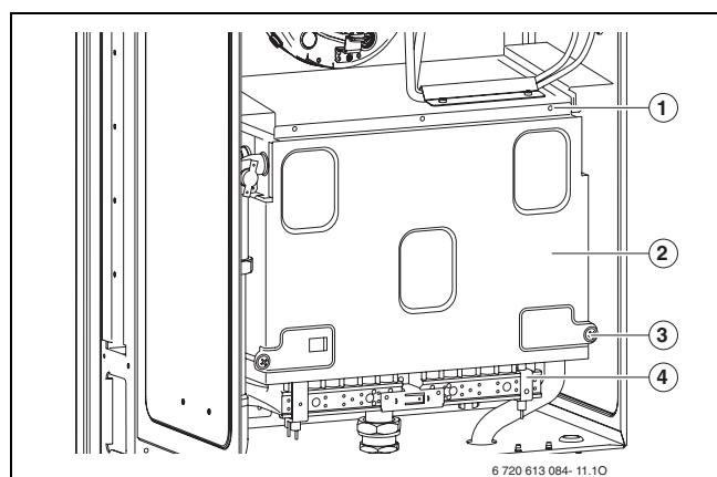
Рис 56 Открывание горелки
