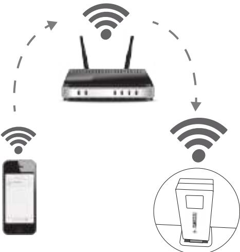
Если приложение предложит обновить прошивку Управляющего модуля, обязательно сделайте это, следуя инструкции в приложении. Возможно, чтобы обновления вступили в силу, Управляющий модуль придется вынуть из usb-порта прибора и вставить обратно.
