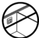
Не размещайте терморегулятор на внутренней стороне плохо изолированной наружной стены.
