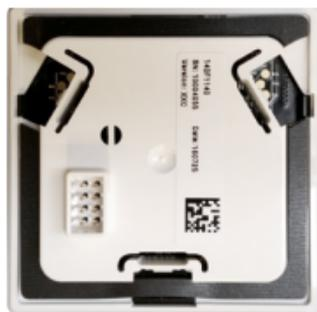
Можно также установить режим «только датчик температуры воздуха»; для этого необходимо сломать, например с помощью отвертки, маленькую пластмассовую перемычку на задней
