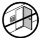
В режиме совместного использования датчика температуры пола и датчика температуры воздуха или в режиме использования только датчика температуры воздуха всегда размещайте терморегулятор на расстоянии не менее 50 см от окон и дверей во избежание влияния сквозняков.
