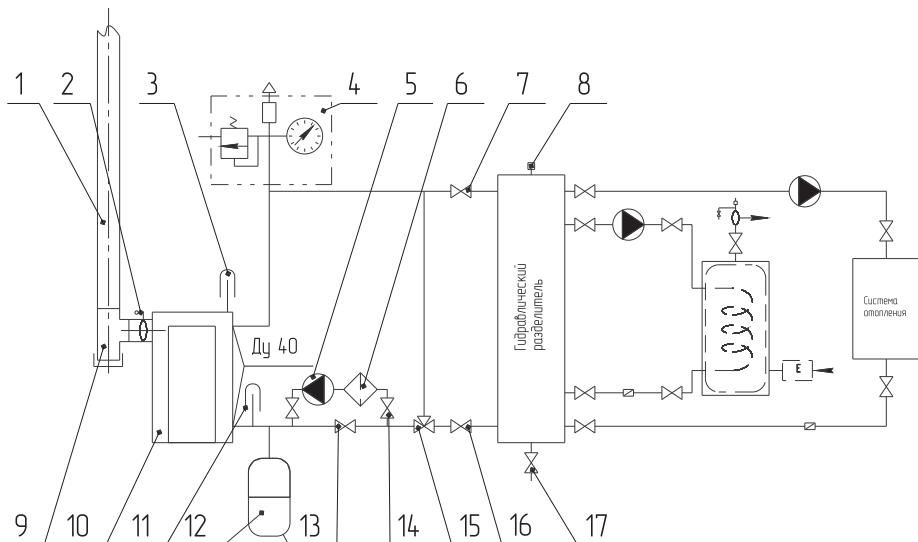
[1] Дымоход. [2] Шибер поворотный. [3] Встроенный термометр на подаче. [4] Группа безопасности. [5] Насос. [6] Фильтр сетчатый. [7] Кран подачи. [8] Воздушный клапан. [9] Тройник с ревизией. [10] Котёл. [11] Термометр обратки. [12] Бак расширительный. [13] Кран байпасный или обратный клапан. [14] Краны линии насоса. [15] Трехходовой клапан. [16] Кран обратки. [17] Кран дренажа/подпитки системы
