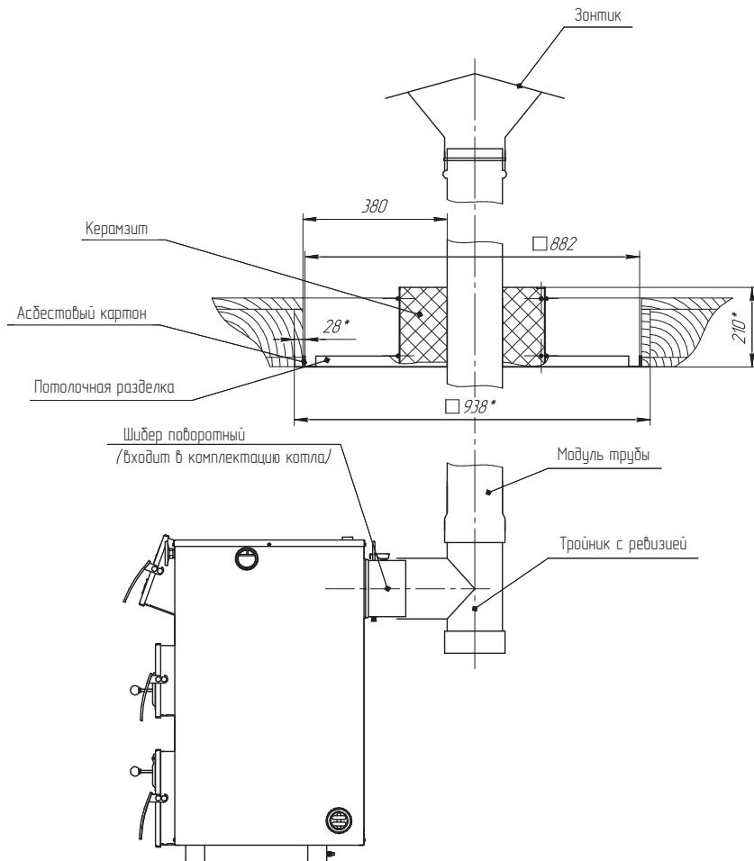
**Рис. 4 Рекомендуемые схемы подключения котла к системе дымоотведения**
