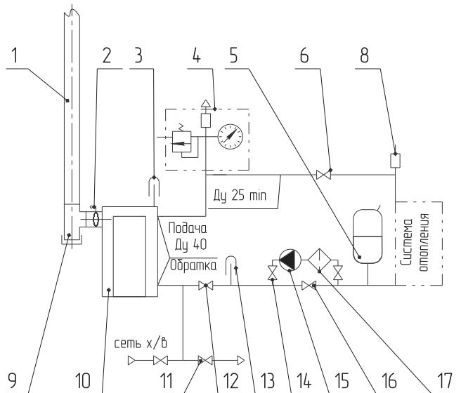
[1] Дымоход. [2] Шибер поворотный. [3] Встроенный термометр на подаче. [4] Группа безопасности. [5] Бак расширительный. [6] Кран подачи. [7] Кран подпитки системы водой. [8] Воздушный клапан. [9] Тройник с ревизией. [10] Котёл. [11] Кран дренажа. [12] Кран обратки. [13] Термометр обратки. [14] Краны линии насоса. [15] Насос. [16] Кран байпасный или обратный клапан. [17] Фильтр сетчатый.
