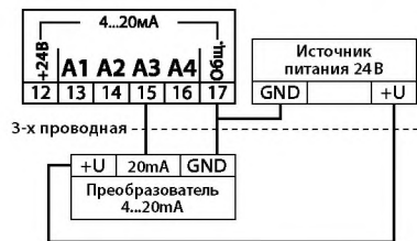
Рис. 18. Схемы подключения преобразователей в унифицированный сигнал 4...20 мА
