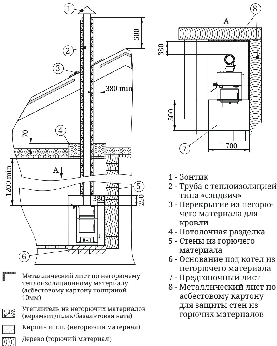
Рисунок 3. Монтаж котла «Оптимус» Система отопления условно не показана
