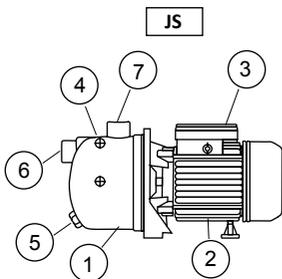
При работе насос с помощью вращающегося рабочего колеса и внутреннего эжектора всасывает воду из источника и нагнетает ее под давлением в напорную магистраль. На корпусе насоса расположена идентификационная табличка, на которой указаны следующие данные: Модель, серийный номер (первые четыре цифры серийного номера обозначают дату изготовления в формате ММГГ).
