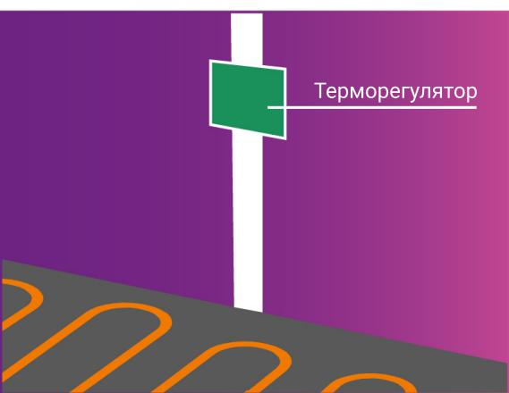
Измерьте сопротивление кабеля, чтобы проверить работу системы, сверив показания с таблицей в руководстве. Подключите систему к терморегулятору.
