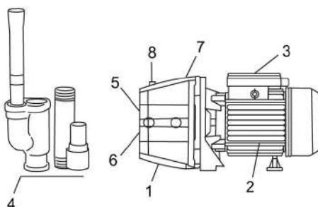
Насос состоит из следующих основных узлов: гидравлической части – (1), электродвигателя – (2), пускового устройства – (3) и внешнего эжектора (4).
