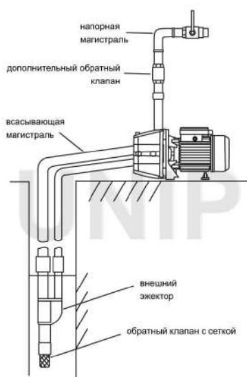
Перед подключением обязательно проверьте соответствие электрических и напорных данных изделия параметрам вашей электрической и водонапорной сети.
