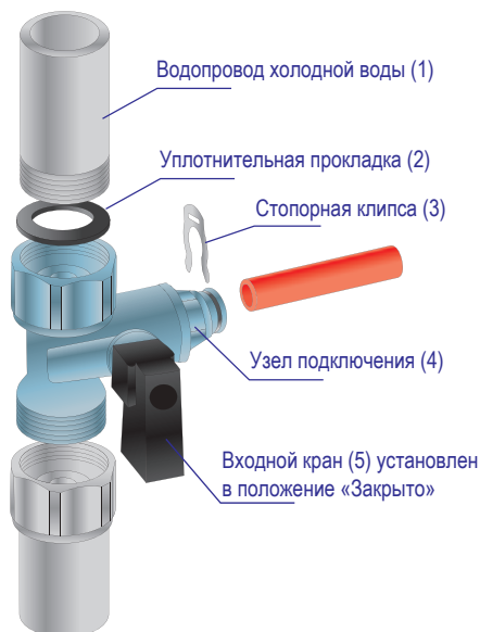
Рис. 3. Схема установки узла подключения
