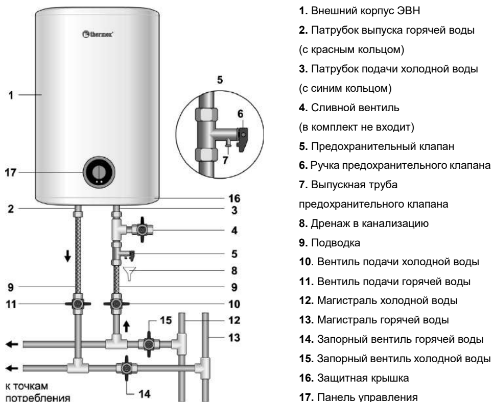
Рисунок 2. Схема подключения ЭВН к водопроводу
