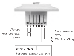
Рисунок 4. Схема подключения к терморегулятору
