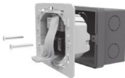
Рисунок 6. Установка терморегулятора в монтажную коробку
