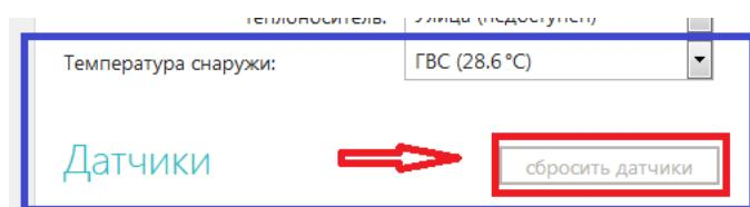
Проводные термодатчики должны подключаться первыми. Если сначала зарегистрировать радиотермодатчики, то может возникнуть ситуация, когда подключенные потом проводные не будут и отображаться в web-интерфейсе. Исправить эту ситуацию возможно, используя команду «Сбросить датчики» личного кабинета Интернет-сервиса ZONT.
