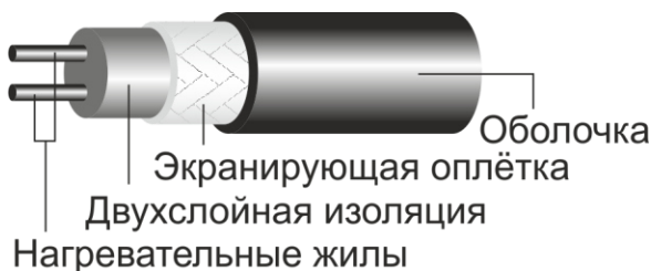
Рисунок 3 - Устройство нагревательного провода.
